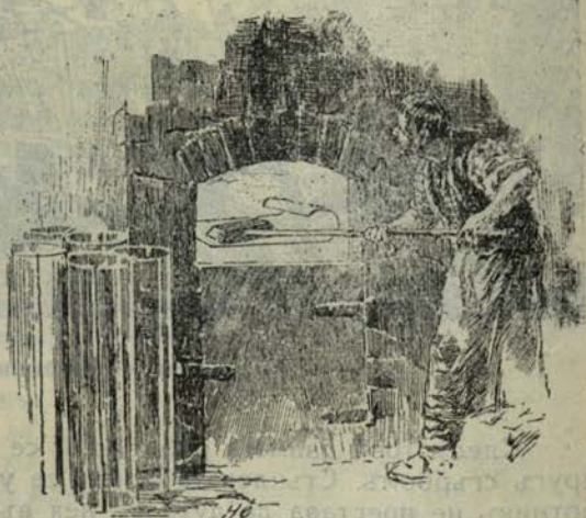
Оглаждане на разтворения стѣкленъ цилиндъръ.
